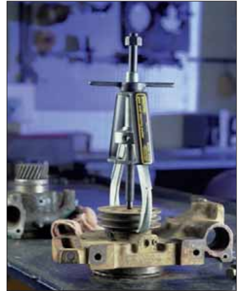
▲ Un extractor de 2 mordazas EP-204 en posición para extraer la polea de mando de una bomba de agua.
