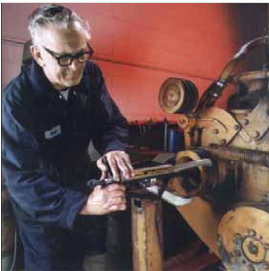
◀ Colocación de un extractor de 3 mordazas EP-104 en la transmisión de un motor diesel.
